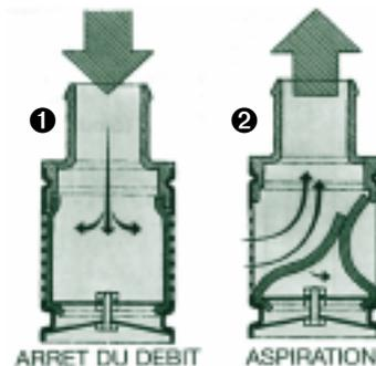
Réalisés en acier galvanisé à chaud. Le clapet de pied COPAFLASH présente l'avantage essentiel de fonctionner dans toutes les positions
